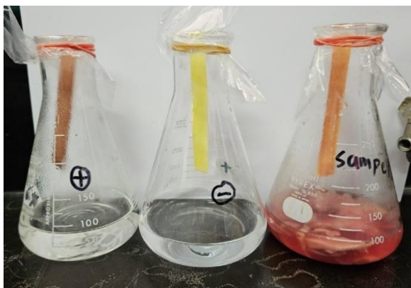
Gambar 4. Perubahan pada kertas pikrat pada pengujian sianida kualitatif
